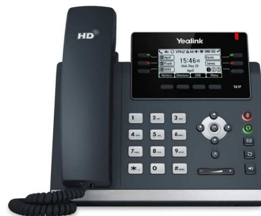
Yealink T42U Téléphone IP – PoE - Ecran noir et blanc 2.7 pouces 6 touches programmables – ports Ethernet
